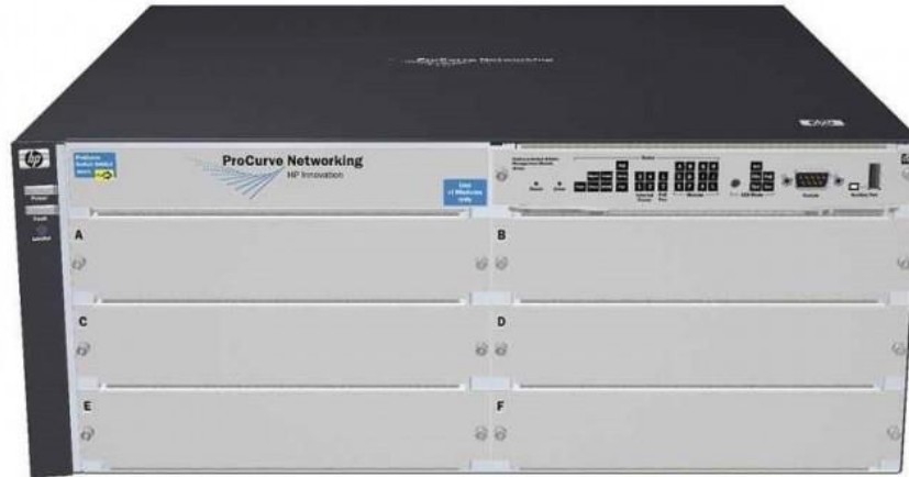
Figure 16 - Le switch cœur de réseau
